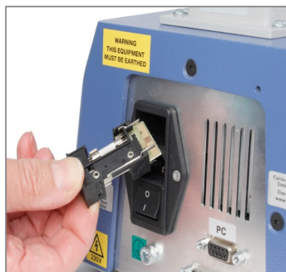
Nosilec odstranjen za zamenjavo varovalk
