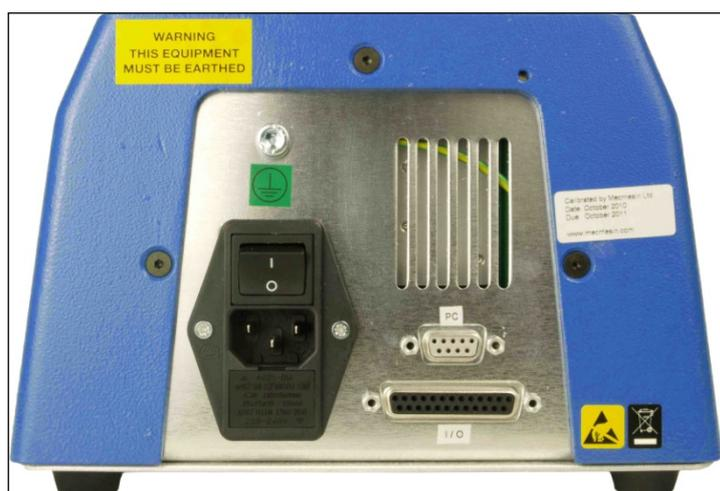
Vue de dos d'un MultiTest-xt. Branchez le câble USB sur la prise 9 broches marquée "PC"
