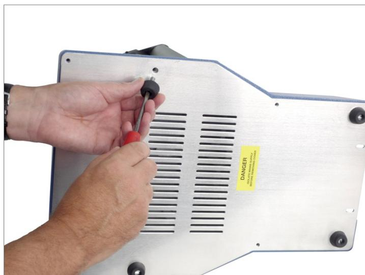
Fixation des pieds en caoutchouc à la base du banc d'essai
