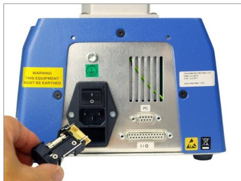
Il est possible de changer le voltage choisi en coupant l'alimentation et en enlevant le cordon (si fixé). La cartouche à fusibles peut maintenant être retirée. Vérifier que les deux fusibles sont de la même tension et remettre la cartouche à fusibles pour que la tension désirée soit affichée.
