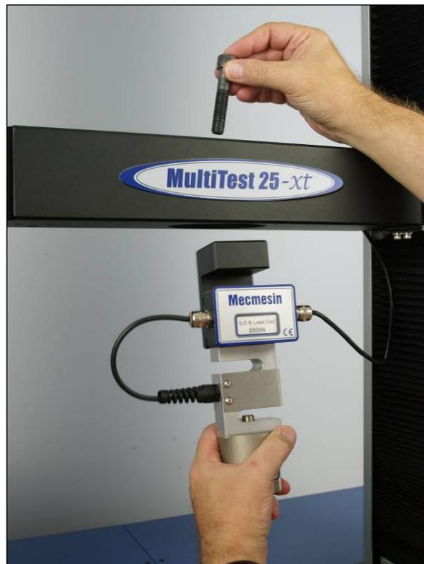
Attacher un capteur sur un banc d'essai double colonne
