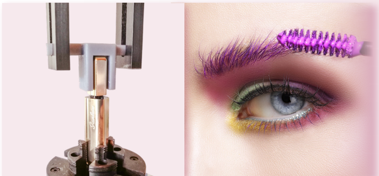
▲ Prüfung des Schliessmoments eines Mascara-Behälters
