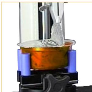
耐蒸煮复合膜的剥离测试
