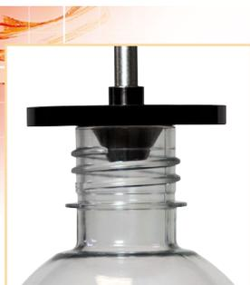
用排气式压盘进行顶压测试
