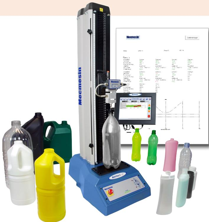
使用Mecmesin触屏控制系统——Multitest 5-xt PET瓶进行顶压测试，可生成个性化详细的测试报告。
