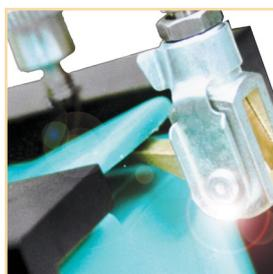
弹扣盖压力测试
