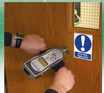
porte à tambour    barrière automatique    tester la force de relâchement de la barre de sécurité    tester la force pour ouvrir une porte incendie
