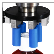
Тестирование крышек с функцией защиты от детей
