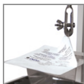
Испытание на отрыв упаковки контейнера
